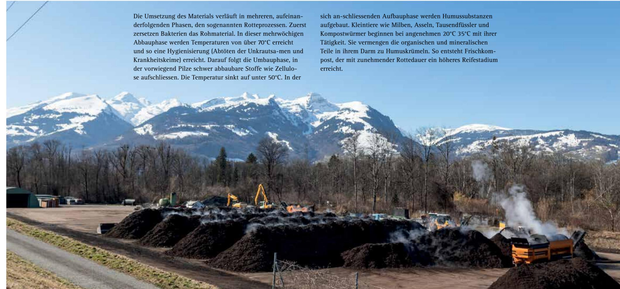
Die Umsetzung des Materials verläuft in mehreren, aufeinanderfolgenden Phasen, den sogenannten Rotteprozessen. Zuerst zersetzen Bakterien das Rohmaterial. In dieser mehrwöchigen Abbauphase werden Temperaturen von über 70°C erreicht und so eine Hygienisierung (Abtöten der Unkrautsamen und Krankheitskeime) erreicht. Darauf folgt die Umbauphase, in der vorwiegend Pilze schwer abbaubare Stoffe wie Zellulose aufschliessen. Die Temperatur sinkt auf unter 50°C. In der
